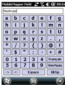
MobileMapper Field possède un large clavier virtuel pour saisir plus facilement les données sur le terrain. Ce clavier s'affiche automatiquement à l'écran dès que l'option est activée et que vous tapez dans un champ modifiable par l'utilisateur.
